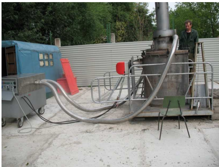
Рис.7 Установка утилизации (сжигания) отходов «Форсаж-2М» (ООО «УНР-17»)
