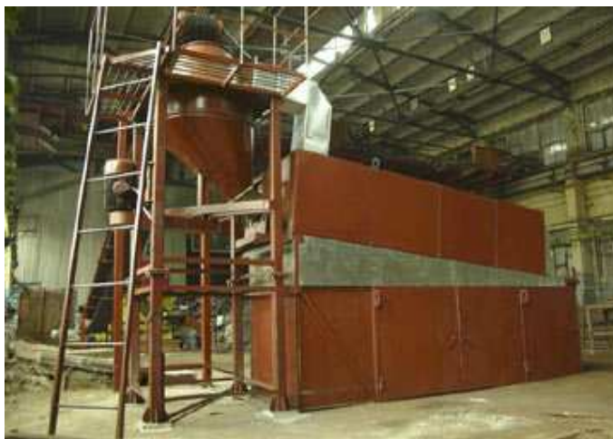
Рис.14 Установка по утилизации руберойдно-битумных кровель компании «ИНЭКОВИР»
