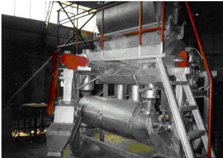
Рис.8 Установка для демеркуризации ртутьсодержащих ламп (модульная) типа УДМ-3000 (ООО «Инжиниринг»)
