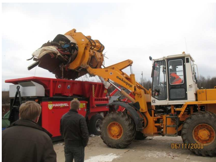
Рис.6 Измельчитель крупногабаритных отходов «Hammel» VB 750 D (Германия) и фронтальный погрузчик «Амкадор»
